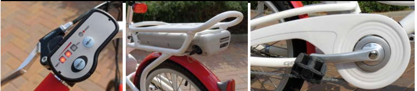
אופניים עירוניים: סבל מרכזי יציב ועמיי; סבל אחורי המובנה בשלדה; סוללה מבית פנטוניק הניתנת לשליפה; כיסוי לאוכף המיועד לחניה בגשם; כנפונים להגנה מפני גשם – בדיוק כמו בג'יפ "המזהם" של השכן...
