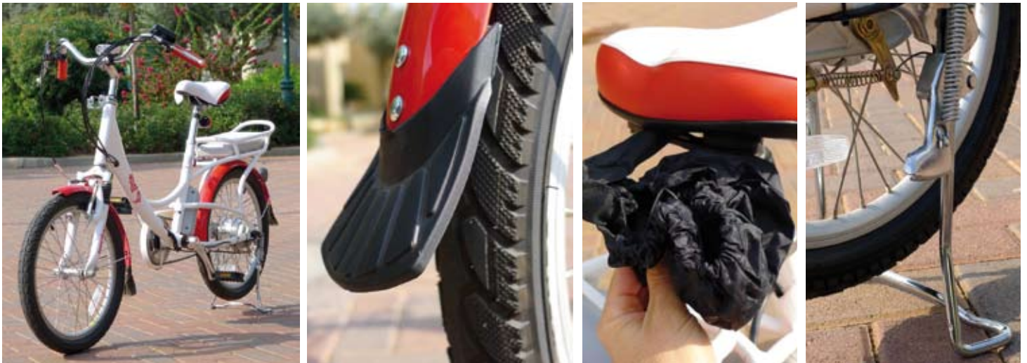
אופניים עירוניים: סבל מרכזי יציב ועמיי; סבל אחורי המובנה בשלדה; סוללה מבית פנטוניק הניתנת לשליפה; כיסוי לאוכף המיועד לחניה בגשם; כנפונים להגנה מפני גשם – בדיוק כמו בג'יפ "המזהם" של השכן...
